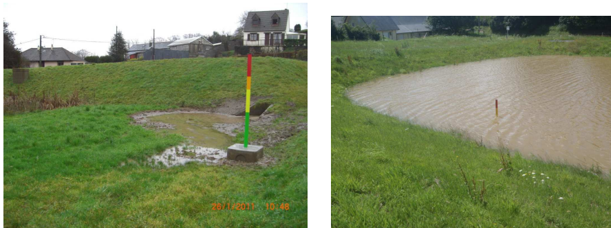
Figure 2 : pige limnimétrique à mettre en place
